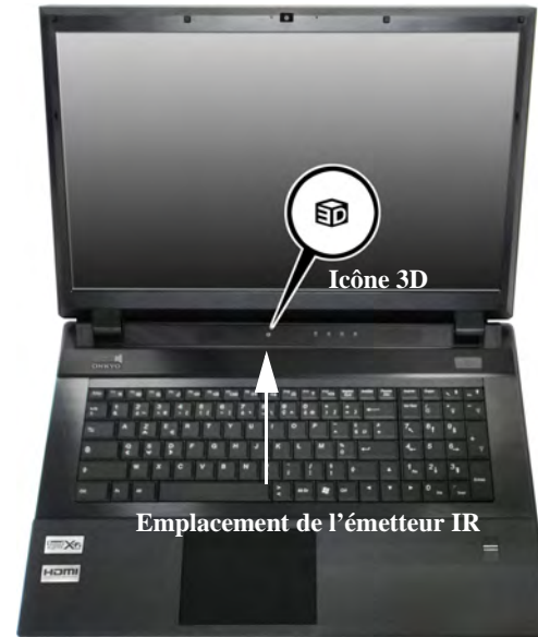
Figure 15 - Emplacement de l'émetteur IR
