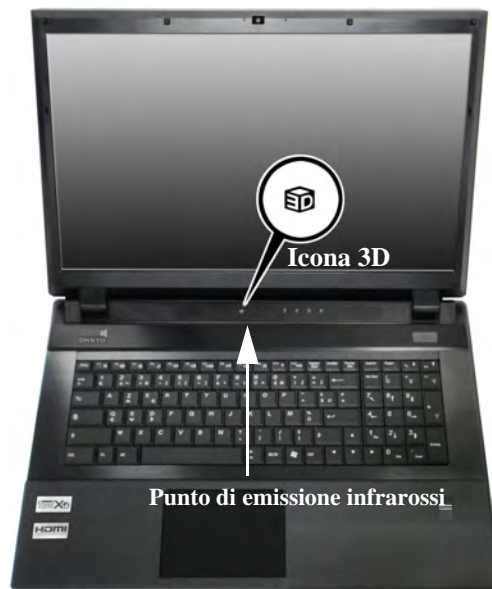
Figura 15 - Punto di emissione infrarossi
